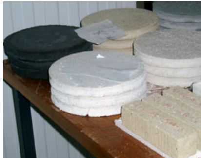
Fig. 10 - Argamassas com diversas pozolanas: provetes e painéis experimentais
