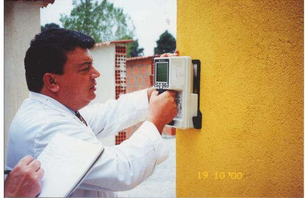
↑ Fig.2 - Identificación del color con espectrocolorímetro
