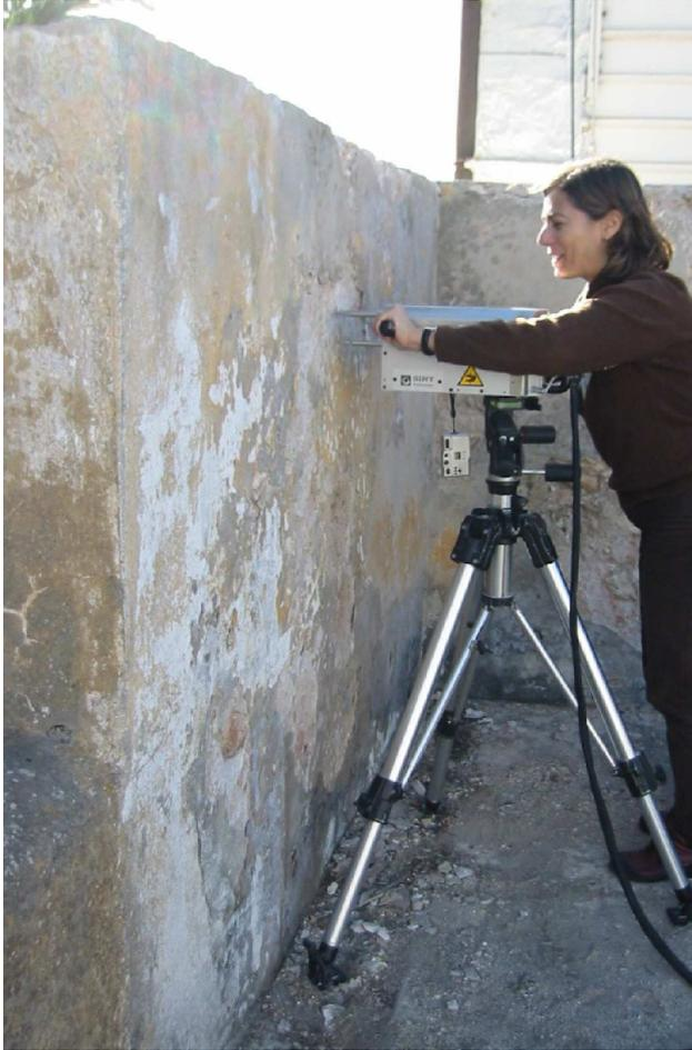
↑ Fig.9 - Ensayo de microperforación
