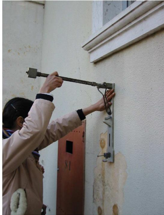
↑ Fig.8 – Ensayo de penetração controlada
