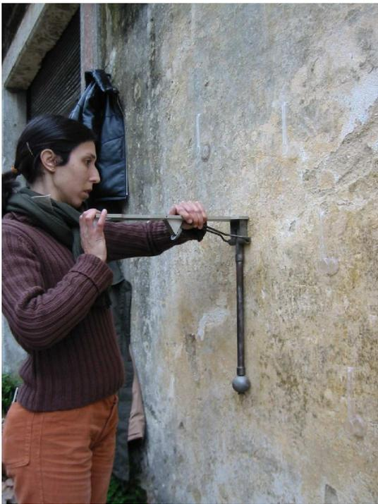
↑ Fig.7 – Ensayo de choque de esfera
