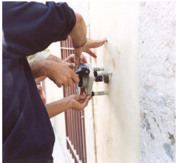
↑ Fig.10 - Ensayo de adherencia por tracción
