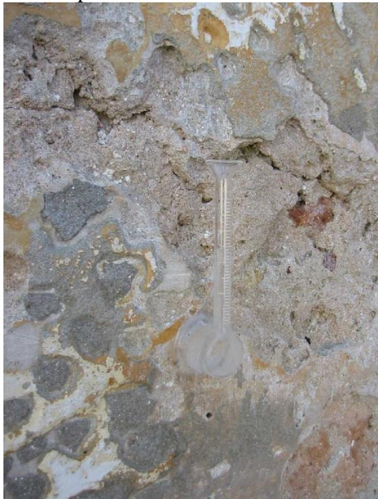
← Fig. 5 – Ensayo de permeabilidad con Tubos de Karsten
