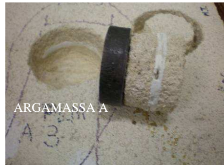
Fig.4 – Provetes após o ensaio de arrancamento – argamassa A.
