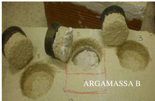
Fig.3 – Provetes após o ensaio de arrancamento – argamassa B .
