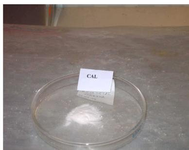
Fig. 1 Resíduo após secagem da água de cal simple
