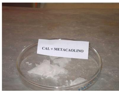
Fig. 2 Resíduo após secagem da água de cal aditivada
