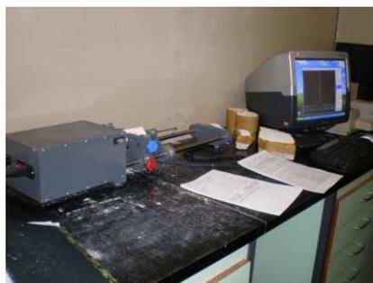
Figura 3 – Equipamento para ensaio de determinação do módulo de elasticidade dinâmico
