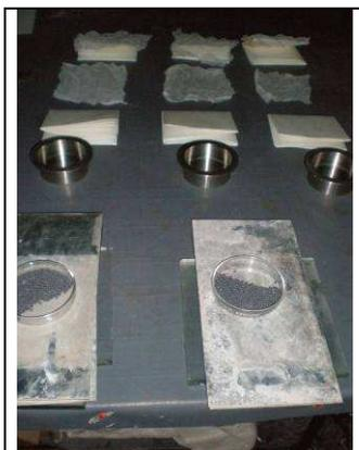
Figura 1 – Material utilizado para o ensaio de determinação da retenção de água.
